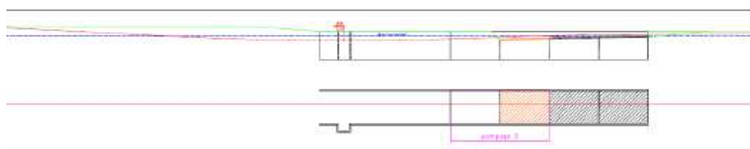
Phase 3 : Réalisation écran + déblais + radier (pompage)
