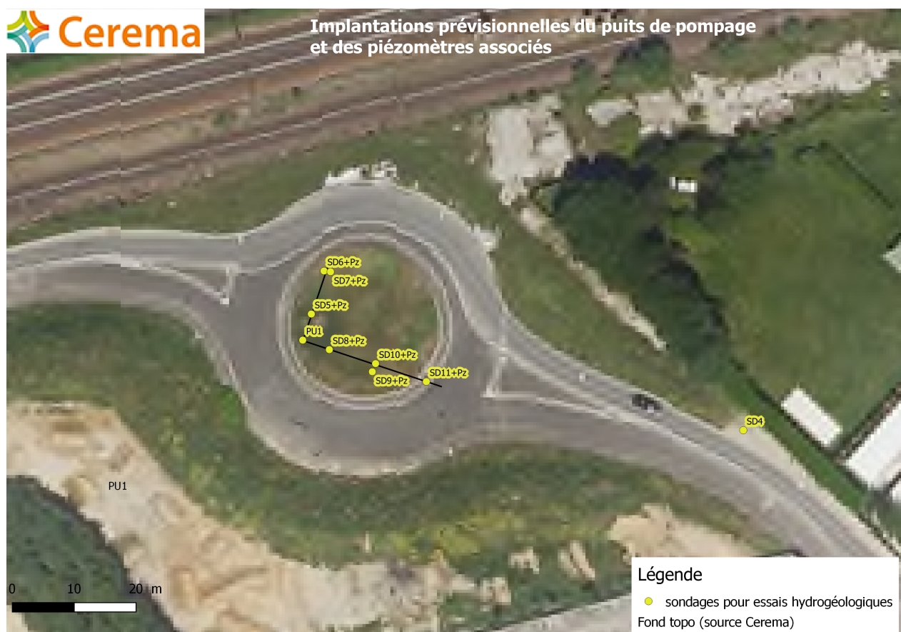
Illustration 10. : Plan d'implantations prévisionnelles du puits de pompage et des piézomètres de suivis (source : Cerema)
